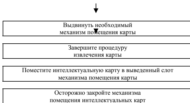
Рис. 5 Блок-схема процедуры помещения интеллектуальной карты
