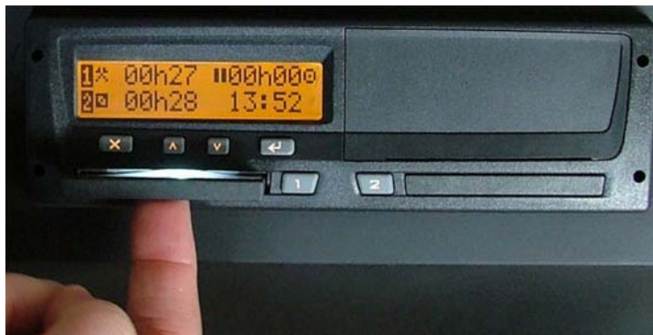
Рис. 7 Извлечение интеллектуальной карты из механизма помещения карты
